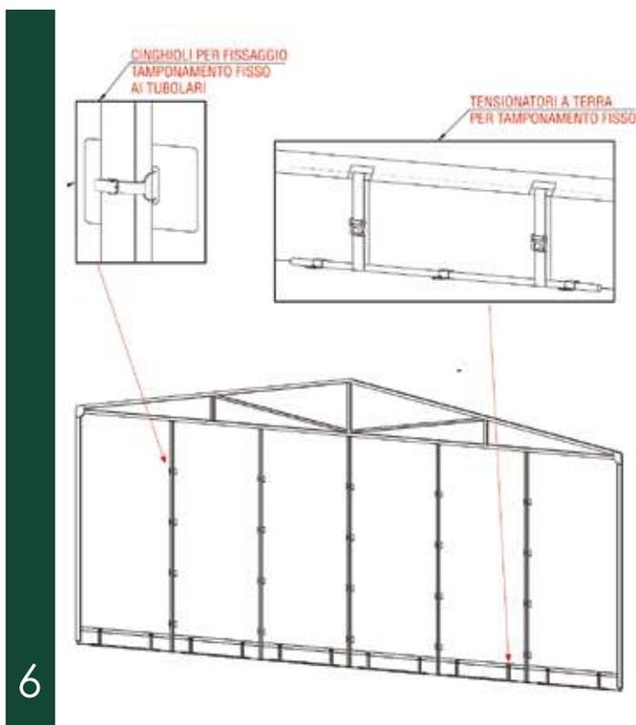
**7. Tende scorrevoli:** tende con sistemi di trazione a cricchetto e paletti antivento con garanzia di resistenza alla spinta del vento. Specifici per zone di transito mezzi e carico/scarico merci.
