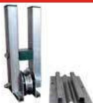
Le ruote in acciaio pieno tropicalizzato, con doppio cuscinetto a sfera a tenuta stagna, scorrono su guide costituite da un profilo di base e da due profili antideragliamento. Corredate da due ganci applicati ai perni ruota, formano il sistema "safewind" che fa da guida alla copertura e ne impedisce il deragliamento e il sollevamento.
